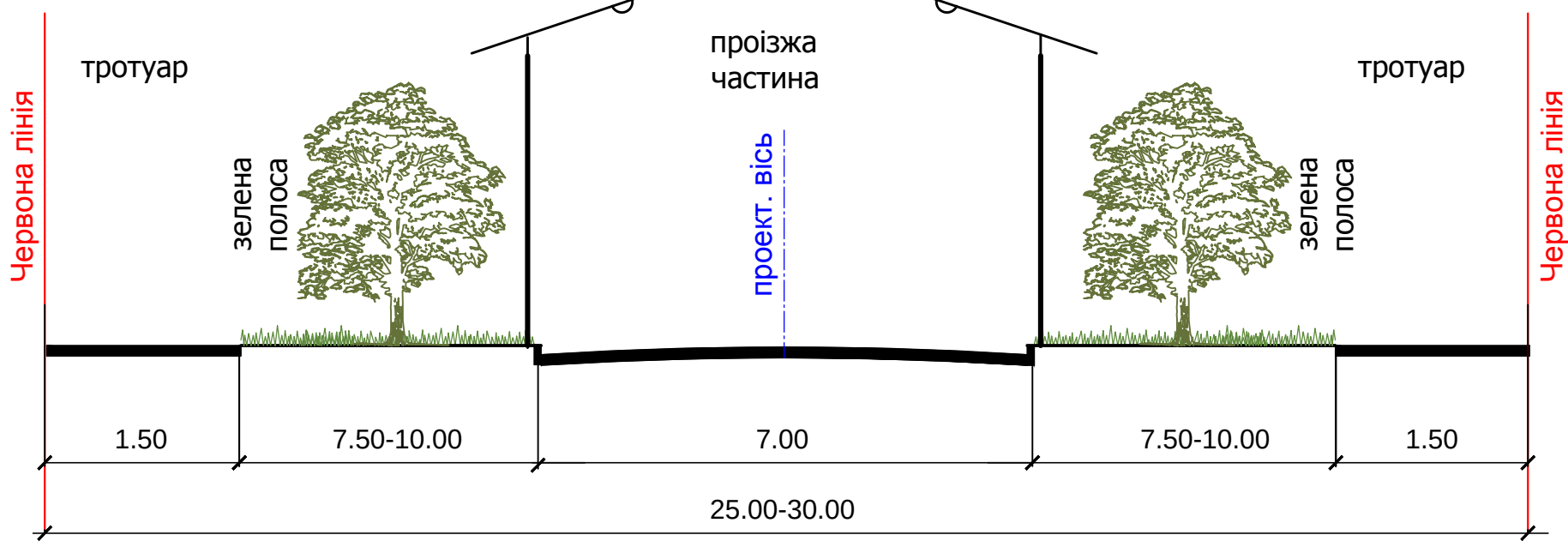
ПОПЕРЕЧНИЙ ПРОФІЛЬ ГОЛОВНИХ І ЖИТЛОВИХ ВУЛИЦЬ
